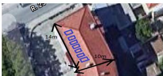
Planta do telhado do edifício escolhido com as medições do edifício e com um esboço da colocação dos painéis (azul)
