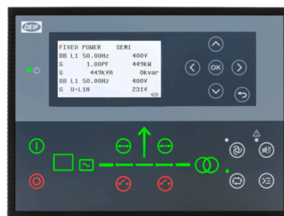
Figura 2.10: Exemplo de controlador com capacidade de fazer o paralelo a rede
