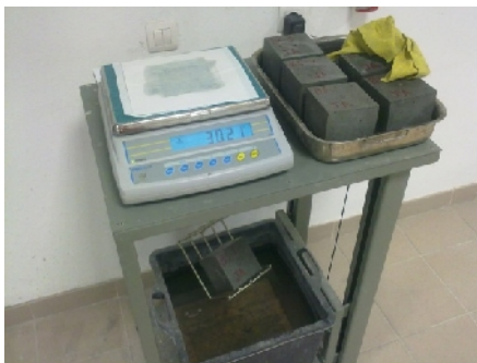
Figura 3.22 – Ensaio de absorção por imersão, pesagem da massa hidrostática
