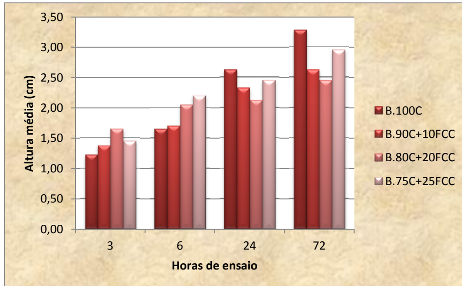
Figura 4.23 – Altura média de água medida ao longo de 4 geratrizes nos provetes de betão no ensaio de absorção por capilaridade.
