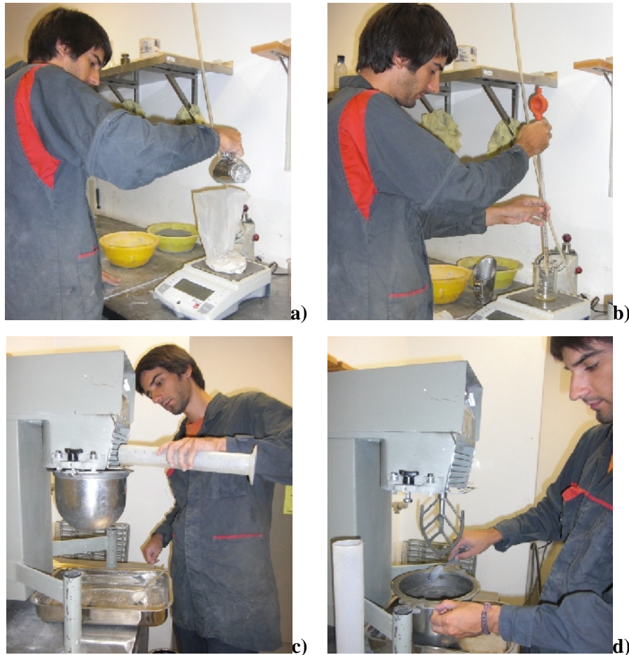
Figura 3.6 – Realização da amassadura de argamassa: a) pesagem do catalisador exausto de FCC; b) pesagem do superplastificante; c) introdução à passagem do 1º minuto de amassadura dos 20% de água misturada com superplastificante; d) pausa para limpeza.
