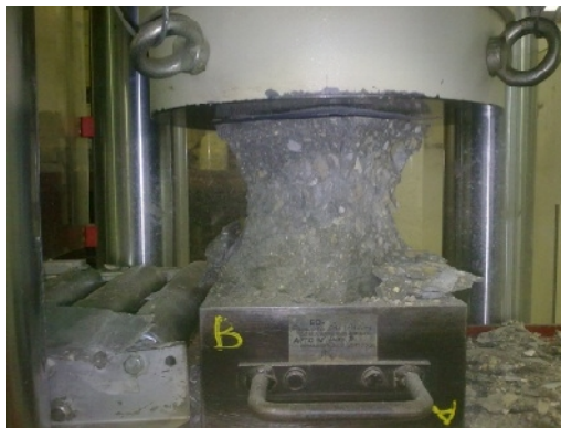
Figura 3.20 – Ensaio de compressão dos betões: provete após o ensaio
