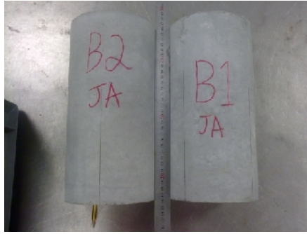
Figura 3.21 – Provetes, e respectiva identificação, do ensaio de absorção por capilaridade
