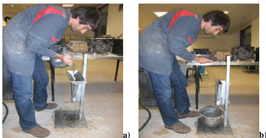
Figura 3.10 – Fases do ensaio de fluidez das argamassas: a) enchimento do funil; b) cronometragem
