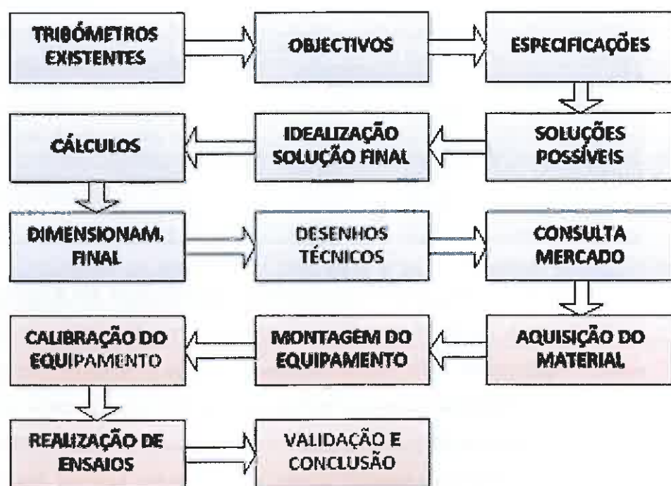
Figura 32 – Esquema das diferentes fases que constituem o projecto e desenvolvimento do Tribómetro
