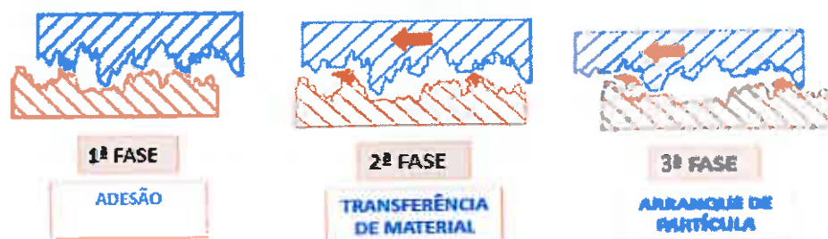
Figura 10- Etapas do desgaste adesivo
