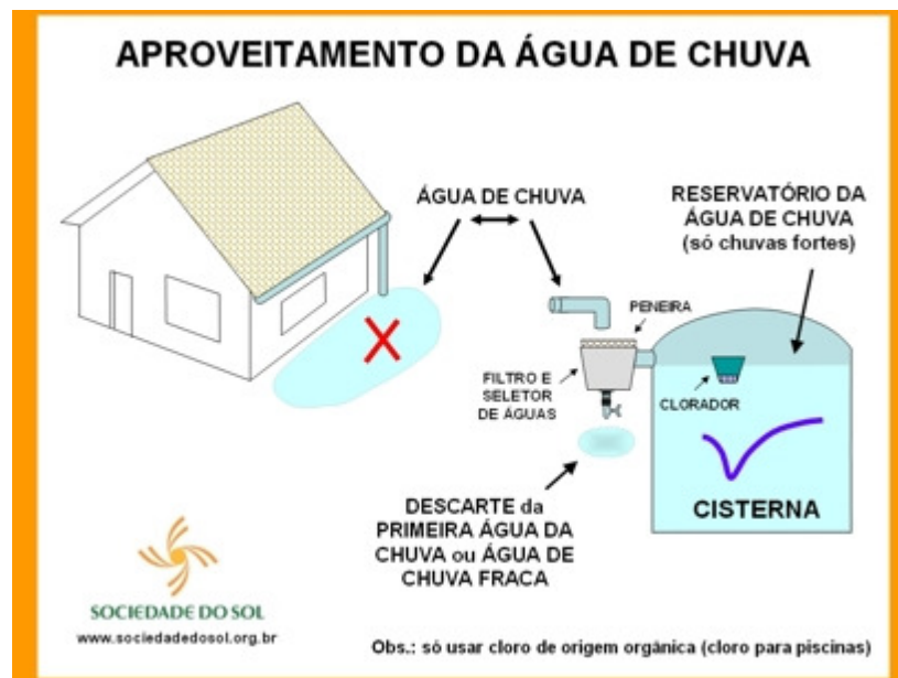
Fig. 29 – Aproveitamento da água da chuva [31].
