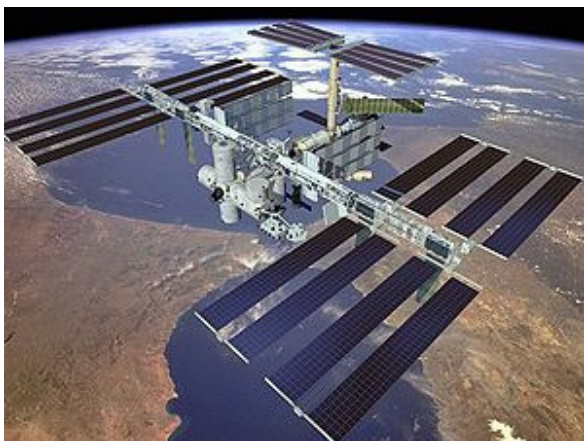
Fig. 22- Painéis solares fotovoltaicos utilizados em aplicações espaciais [25].
