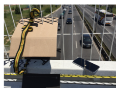
Figura 1 : Método utilizado para medição de som e gravação de vídeo
