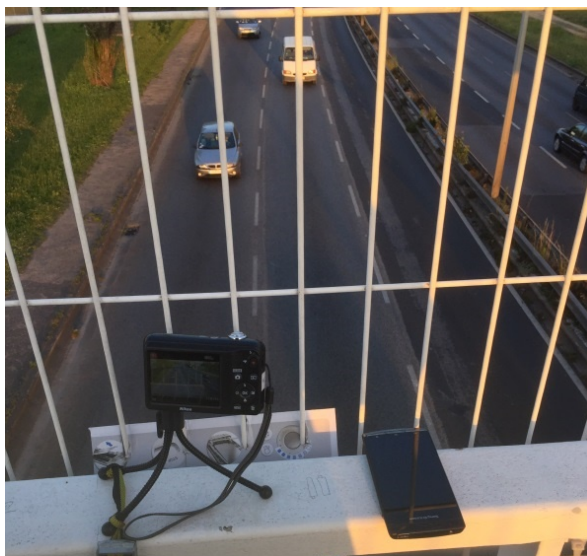
Figura 33 - Esquema de captura de som e imagem montado na ponte pedonal
