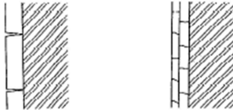
Figura 4.2 - Comportamento distinto consoante o número de camadas em caso de fissuração [23]
