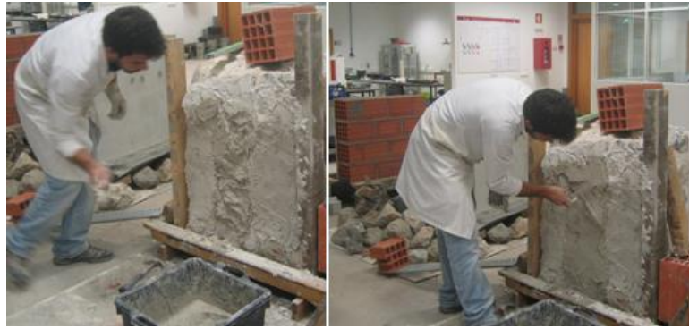
Figura 5.20 - Conclusão da 1ª camada de RBA 01
