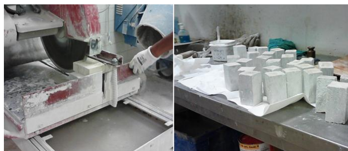
Figura 5.77 - a) Corte das amostras b) Aplicação de impermeabilizante
