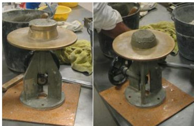
Figura 5.81 - Aspecto da argamassa após remover o molde
