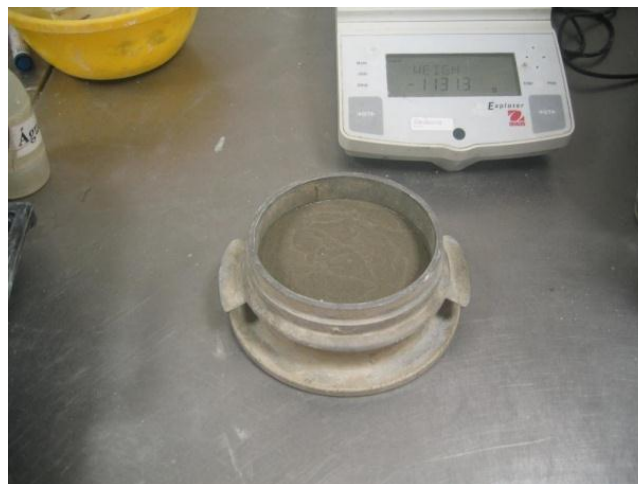
Figura 5.82 - 1ª camada compactada após as 10 pancadas
