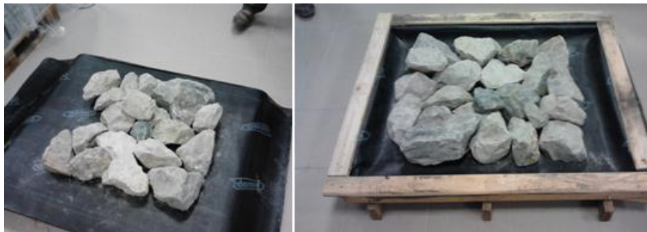
Figura 5.6 - Preparação e colocação de pedras na base
