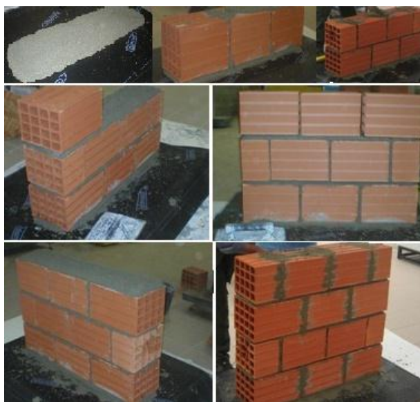
Figura 5.4 - Processo construtivo com as diversas fiadas
