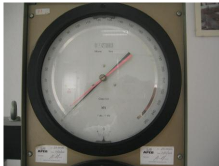
Figura 5.87 - Mostrador do aparelho indicando o valor da força aplicada
