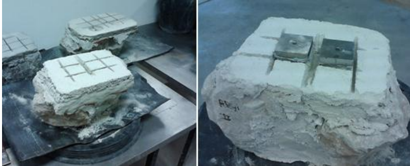
Figura 5.74 - a) Marcação das zonas a colar b) Bolachas quadradas coladas
