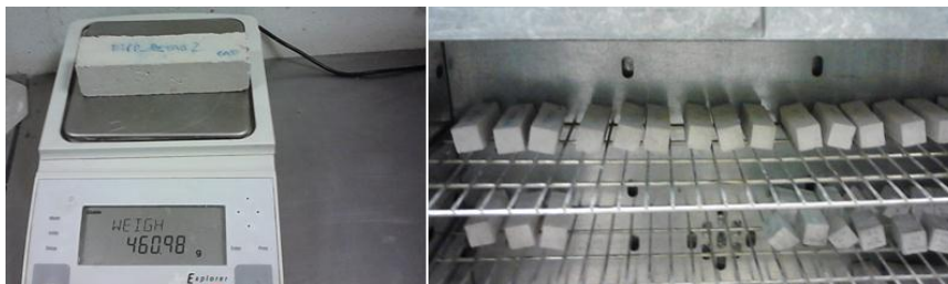
Figura 5.76 - a) Pesagem dos provetes b) Colocação na estufa
