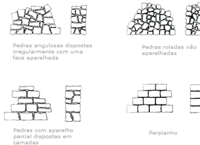
Figura 2.10 - Diferentes tipos de alvenaria de pedra [39]
