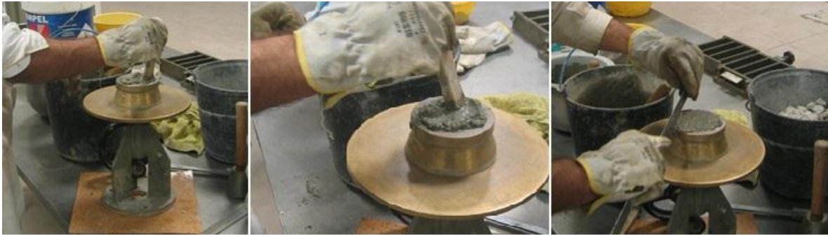
Figura 5.80 - Preenchimento e compactação
