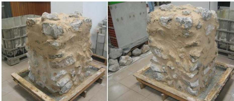
Figura 5.10 a) e b) - Aspecto final da alvenaria ordinária
