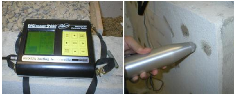
Figura 5.67 - a) Aparelho medidor b) Esclerómetro de Schmidt
