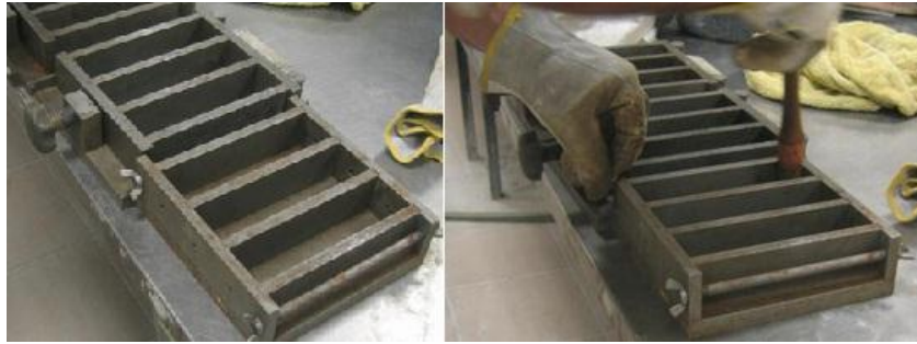
Figura 5.61 - Pincelagem dos moldes com massa consistente
