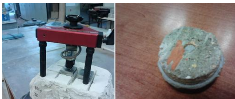
Figura 5.75- a) Posicionamento do aparelho b) Exemplo de rotura mista
