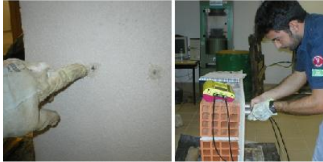
Figura 5.73 - a) Aplicar vaselina nos pontos a ensaiar b) Método indirecto
