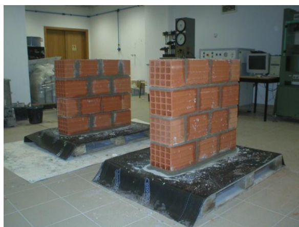
Figura 5.5 - Alvenarias de tijolo concluídas
