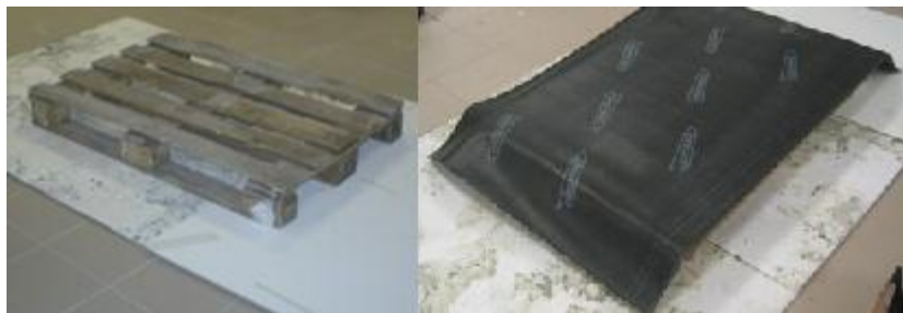
Figura 5.3 - Preparação da base para a execução das alvenarias
