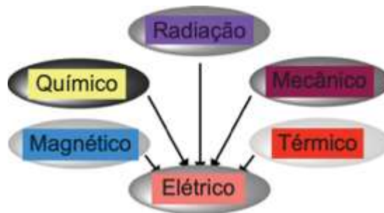
Figura 3.1- Classificação dos sensores de acordo com sinais dos 6 domínios (Fonte: Adaptada de [44]).
