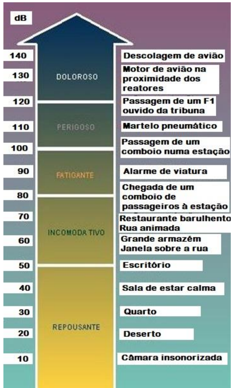
Figura 3.3 - Limites de nível de pressão sonora para diferentes tipos de ruído (adaptado de Agência Portuguesa do Ambiente, 2023)
