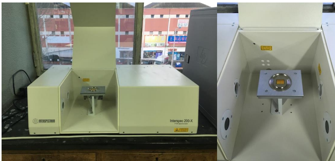
Figura 44 – Espectrofotómetro MIR da INTERSPECTRUM (FTIR-ATR) (esq.) e o dispositivo ATR (dir.).
