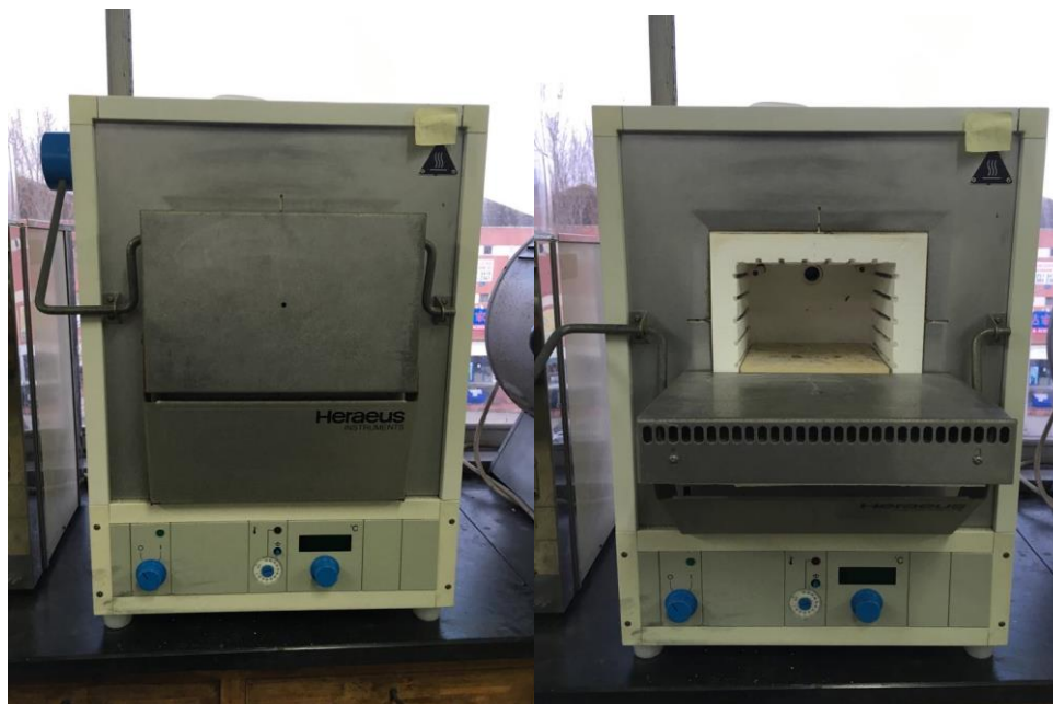
Figura 37 – Mufla utilizada para a ativação de catalisadores.
