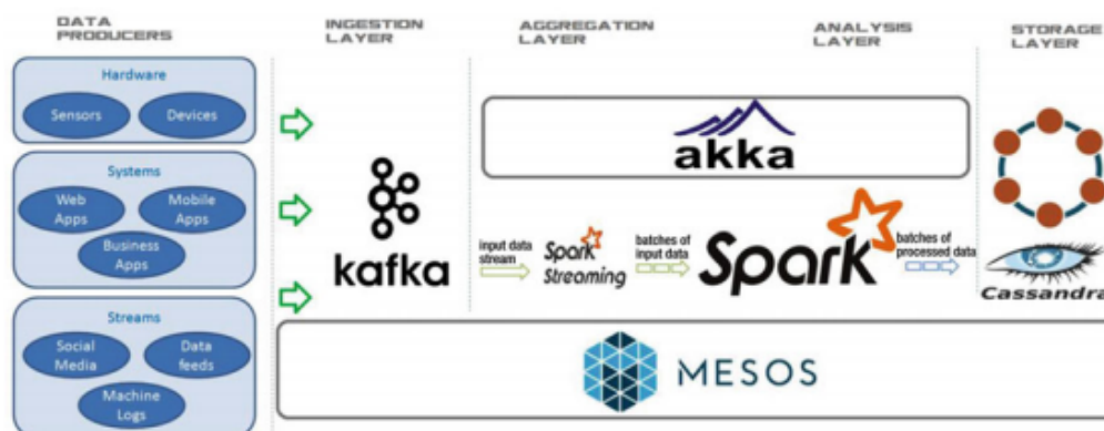
Figura 2.4: Arquitetura SMACK stack , imagem obtida em [40]
