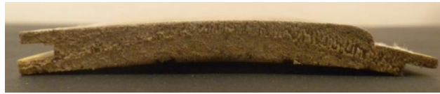
Figura 2.11 - Empeno de uma peça de madeira pela presença de humidade excessiva
