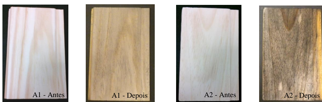
Figura 2.13 - Exemplo dos efeitos dos raios UV (Madeira não tratada - 6 meses de exposição. A1 - Em ambiente salino. A2 - Em ambiente de grande amplitude térmica)
