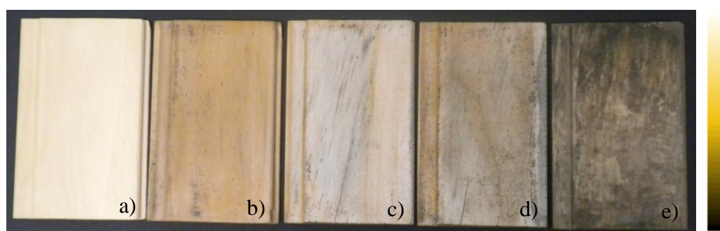
Figura 4.21 - Alteração da cor do produto Madex - Mx. a) Não degradado; b) Lisboa - Lx; c) Ericeira - AS d) Alentejo - Al; e) Terra Laboratorial - TL
