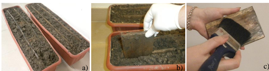
Figura 4.18 - Recolha dos provetes de degradação laboratorial
