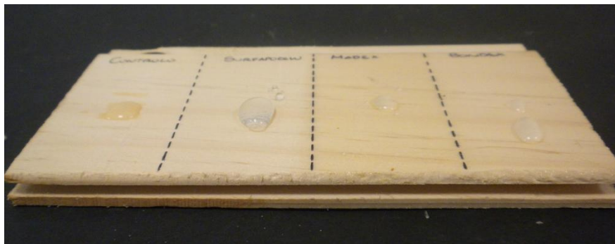
Figura 4.29 - Comparação expedita da impermeabilização à água
