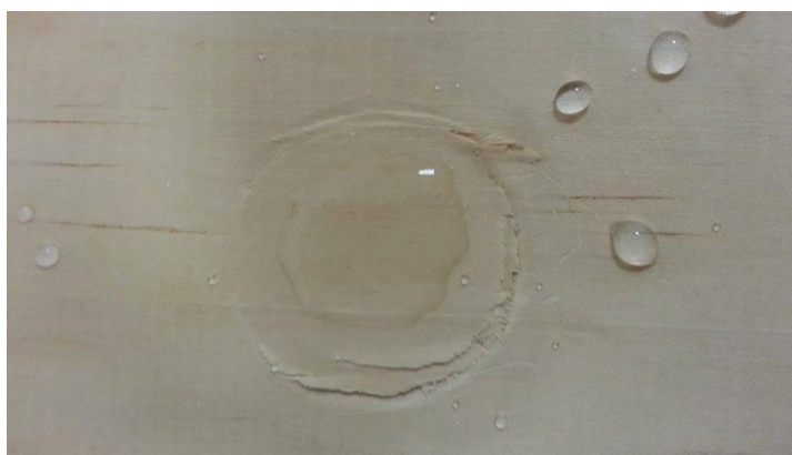
Figura 5.1 - Resultado da pressão exercida pelo tubo de Karsten ao produto SurfaPore W
