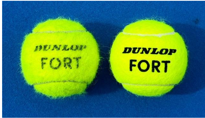
Figura 1.7 – Comparação de duas bolas: uma após 25 minutos de uma sessão de treino (esquerda) e uma completamente nova (direita)
