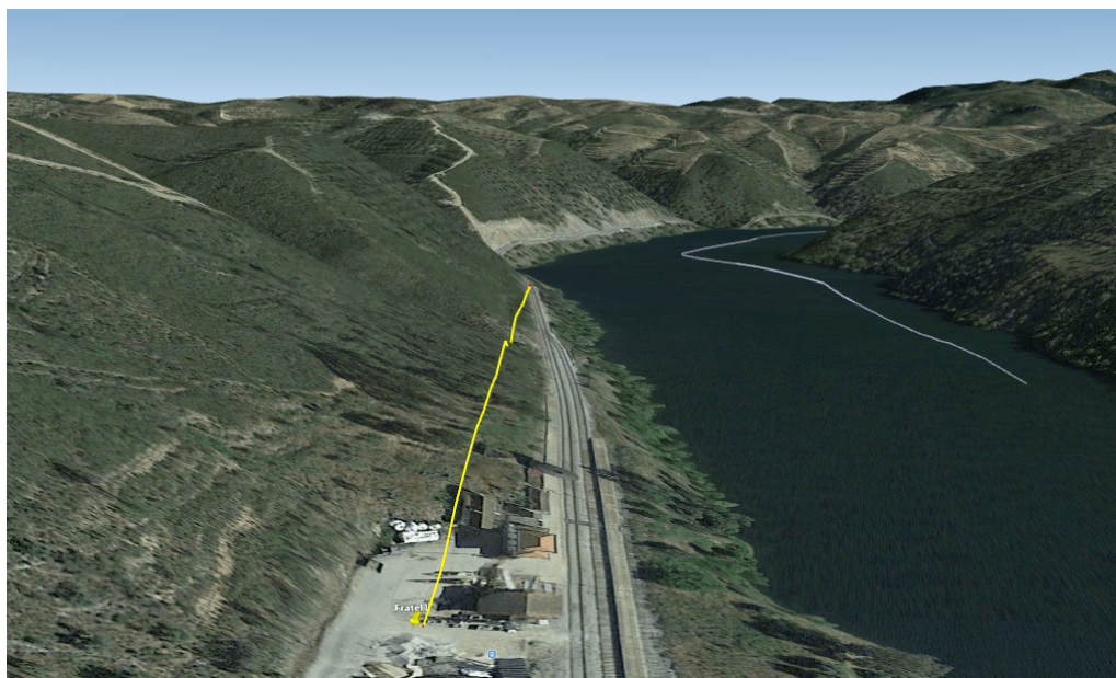
Figura 4.26: Obstrução de terreno junto à estação base Fratel1.
