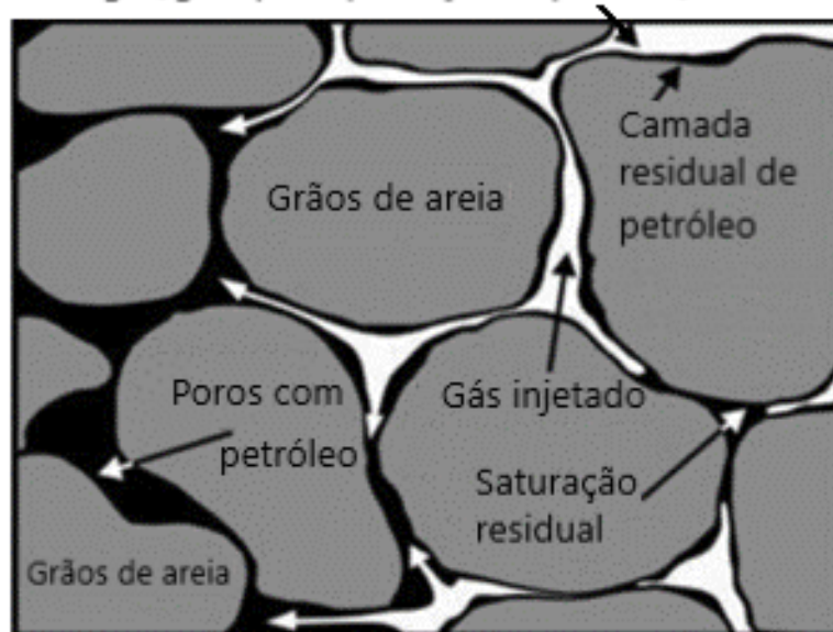
Figura 3.3.1 Esquema da entrada de hidrogénio nos poros e respetiva saída do petróleo (adaptado de Wallace et al. , 2021).
