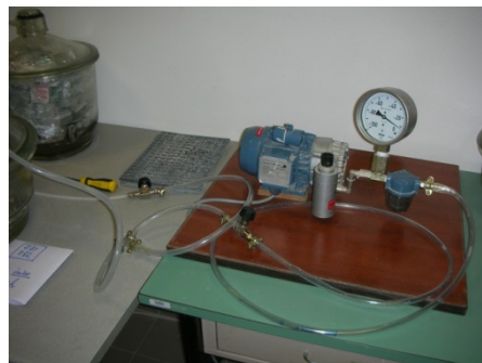
Figura 3.5 Motor elétrico para retirar o ar do exsicador.
