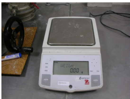
Figura 3.4 Balança com precisão de 0,01% da massa do provete.
