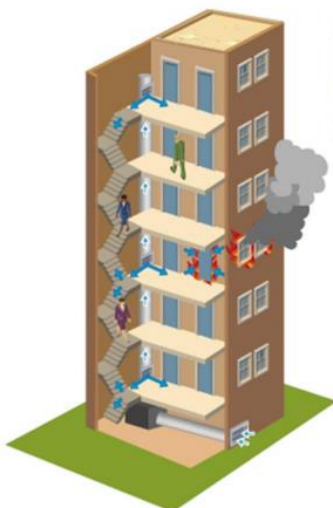
Figura 2.41 – Vias Verticais e Horizontais de Evacuação [1]
