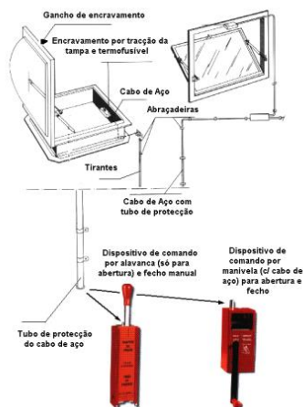
Figura 2.33 – Sistema mecânico de desenfumagem passiva [57]
