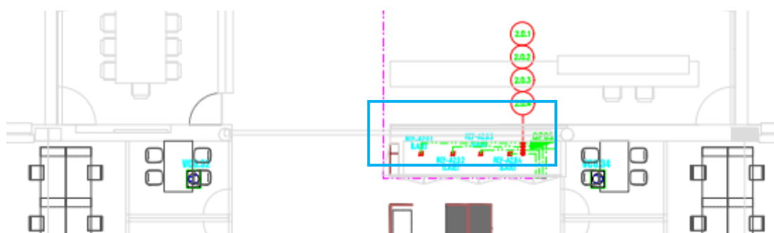
Figura 4.6 – Registos Corta-Fogo instalados nos OpenSpace 1 e 2 do Piso 0
