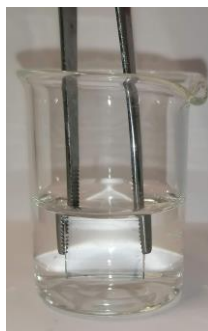
Figura 2.6 – Exemplo do procedimento de imersão em água de um filme de 3-oxetanometanol:PEDOT:PSS depositado em vidro.
