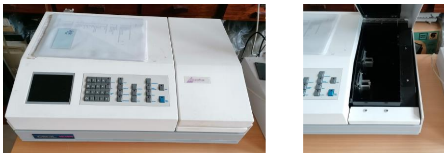
Figura 2.14 – Espectrofotômetro Cecil 7200 utilizado para as medidas de transmitância na região do visível.
