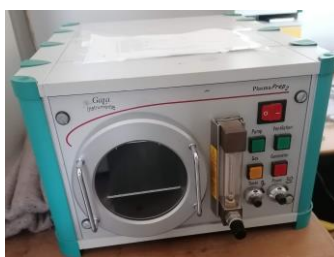
Figura 2.4 – Equipamento utilizado para o tratamento de substratos de PET com plasma de oxigénio.
