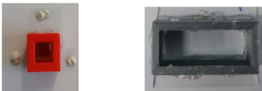
Figura 2.50 – Contentores e contactos de prata depositados sobre os contactos fonte, dreno e porta, utilizados para a medição da impedância.
