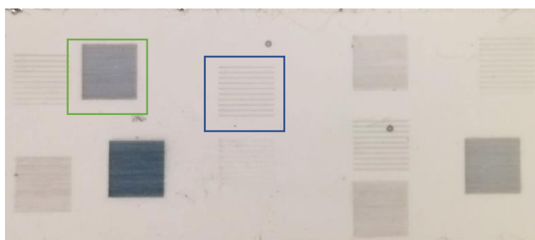
Figura 2.45 – Filmes de PEDOT Orgacon impressos em papel fotográfico. Filme assinalado com quadrado azul representa um filme com espaçamento significativo entre as linhas. Filme assinalado com quadrado verde representa um filme mais compacto.
