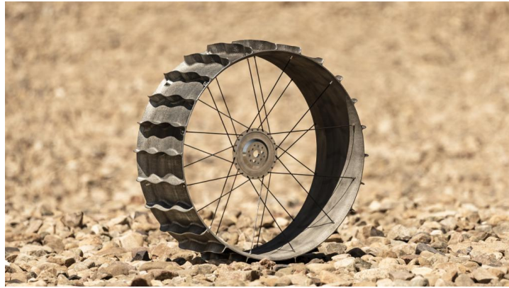
Figura 2.29 - Roda para veículo lunar produzida por impressão 3D pelos investigadores da ORNL [23].
