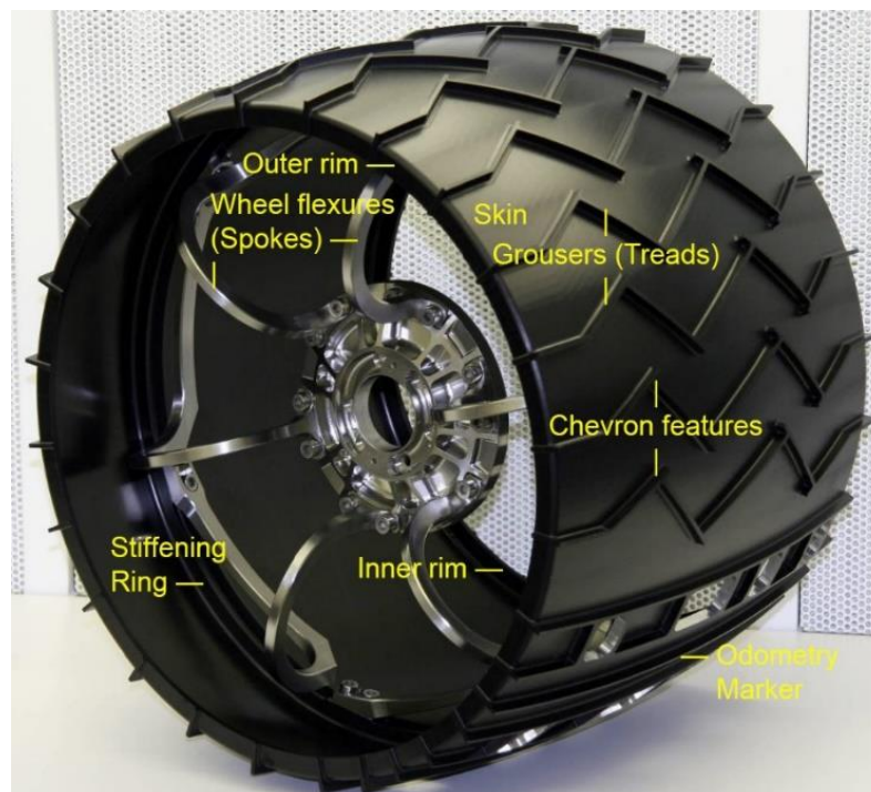
Figura 2.31 - Diagrama do Pneu do Rover Lunar Curiosity antes da montagem, NASA, JPL [26].
