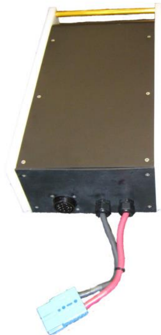
Figura 2.24 - Um conjunto de bateria com 10 células de 3.6 V [20].
