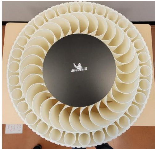
Figura 2.28 - Protótipo de roda lunar produzido por impressão 3D (volumic 3D) em 2022 [22].
