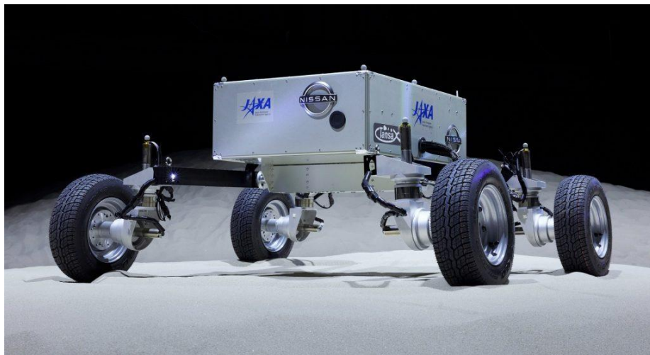
Figura 2.16 - Protótipo de Veículo Lunar desenvolvido com a Agência de Exploração Aeroespacial do Japão [27].
