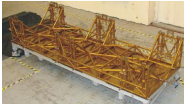
Figura 2.21 - Chassis tubular do Chariot, vindo de fábrica [20].
