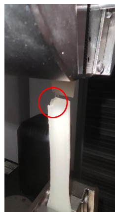
Figura 39 - Defeitos na zona de tração.
