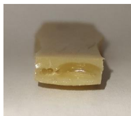
Figura 38 – Defeitos interiores verificados da zona de tração do provete após a realização do ensaio.
