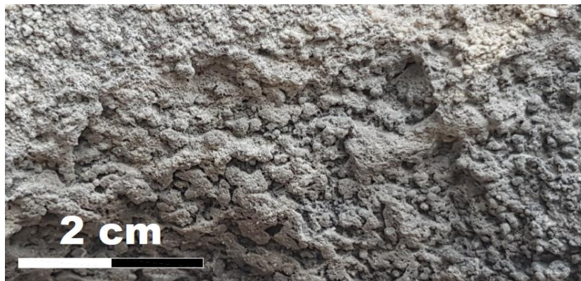
Figura 4.9 - Crostas escuras de cor acinzentada e morfologia esférica.
