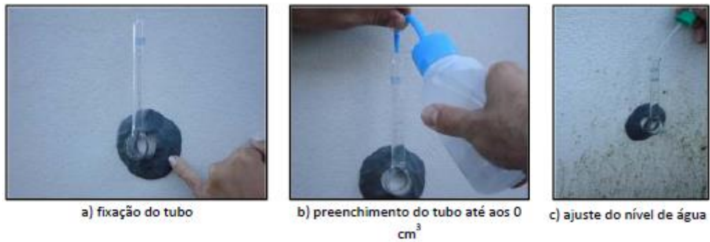
Figura 3.3 - Etapas do ensaio do tubo de Karsten, (Apps, 2011).
