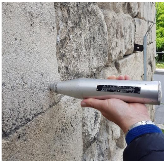
Figura 3.5 - Martelo de Schmidt utilizado no trabalho de campo (Tipo N-34).
