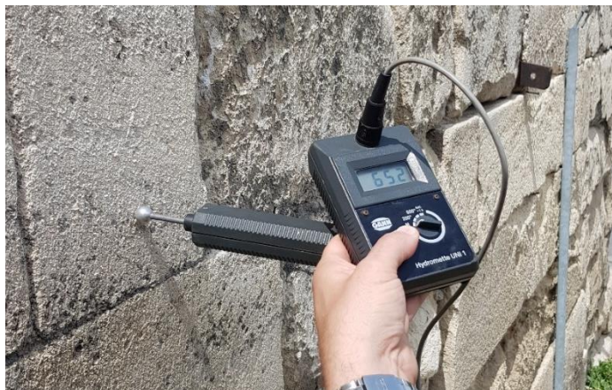
Figura 3.4 - Humidímetro utilizado no trabalho de campo (Gann-Hydromette UNI 1).
