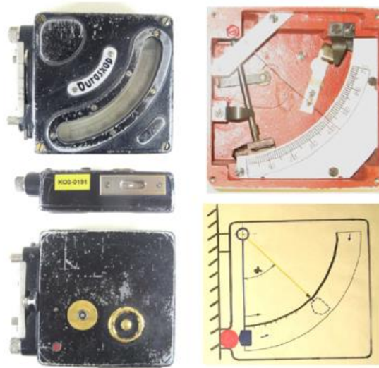
Figura 3.10 - Duroscópio (faces, secção de corte e esquema mecânico).
