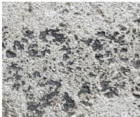
Figura 4.7 - Superfície de uma pedra de calcário bioclástico onde são perceptíveis vestígios da presença de bioclóstos.
