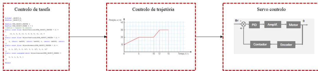
Figura 38 – Etapas do movimento executado por uma junta
