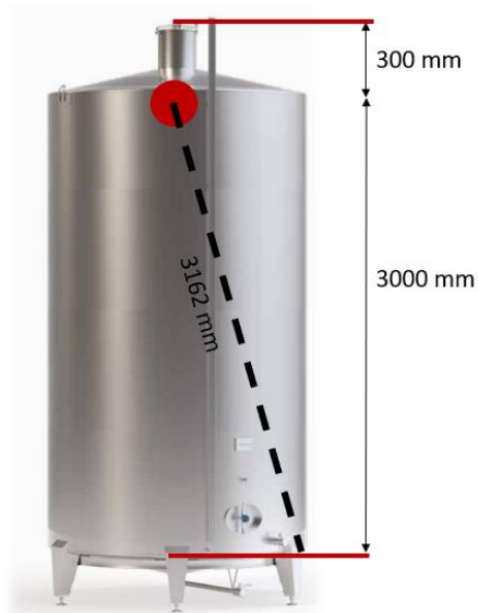
Figura 19 – Distância de alcance dos jatos com a cabeça de lavagem na posição mais desfavorável
