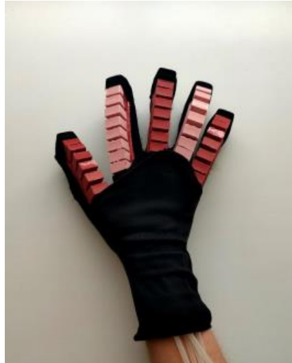
Figura 4.19 - Luva de reabilitação com atuadores pneumáticos em Elastosil® M 4601 A/B [87].
