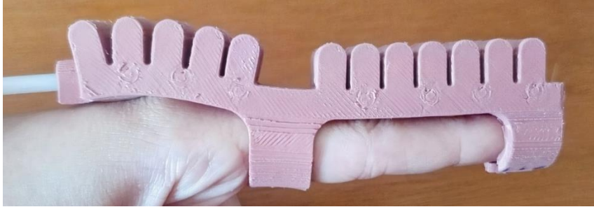
Figura 5.13 - Foto final do atuador Yap adaptado ao exosqueleto em Elastosil M4601 A/B®.
