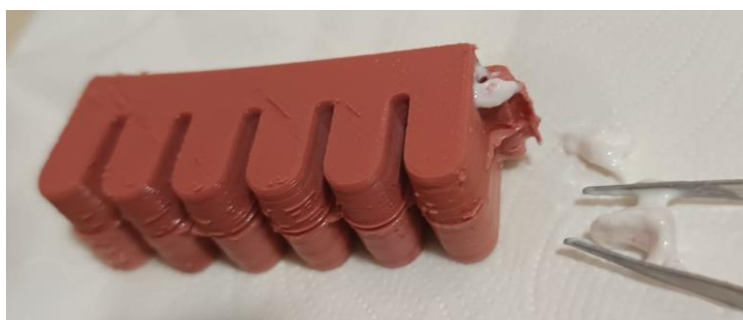
Figura 5.27 - Teste de silicone com espinha ABS dissolvida em acetona.
