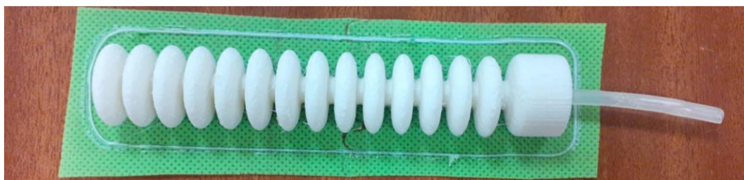
Figura 5.9 - Protótipo do atuador pneumático, adaptado para 2º dedo, no modelo Patel em Filaflex 60A®.
