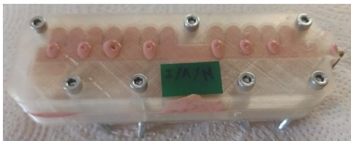
Figura 5.32 - Molde negativo do atuador em silicone: Elastosil M4601 A/B® em cura.
