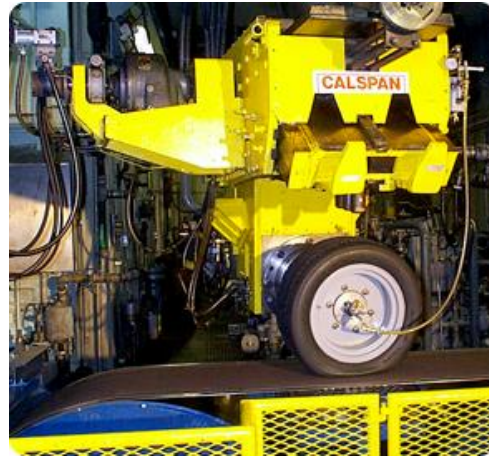
Figura 23: Ensaio de pneumáticos nas instalações de Calspan Tire Research Facility.
