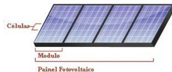
Figura 5.2 - Constituição de painéis fotovoltaicos
