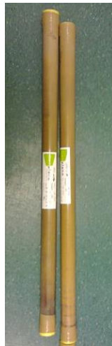
Figura 4.4 – Liners com amostras a diferentes profundidades ( Liner 1 - Esquerda; Liner 2 - Direita).
