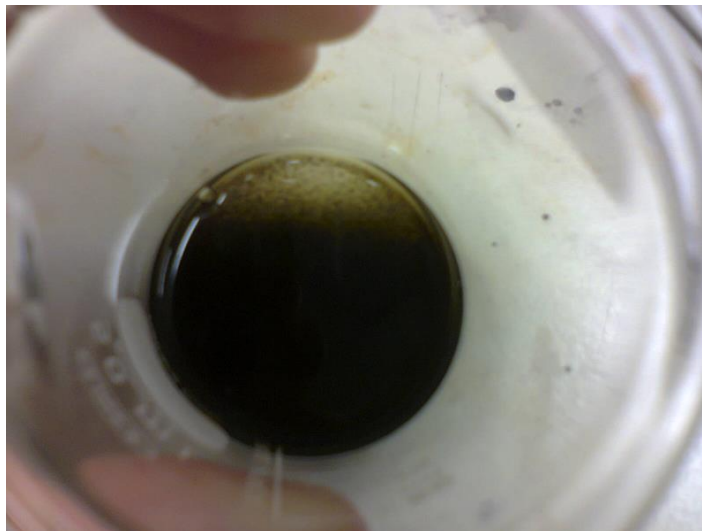
Figura 4.7 – Produção de nZVI verdes a partir do efluente da cozedura da cortiça.
