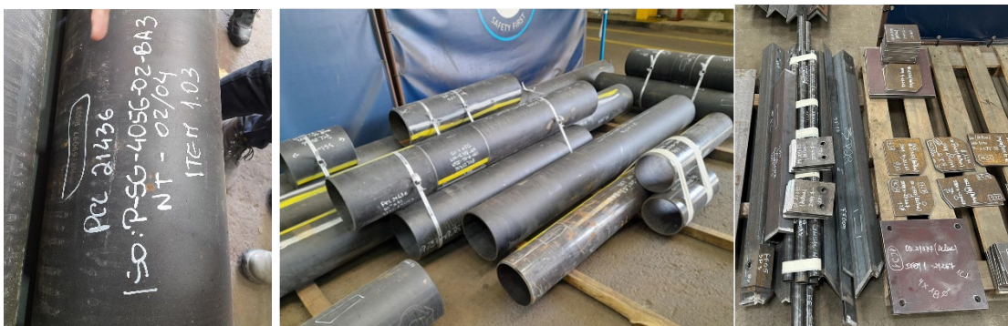
Figura 4.8 - Identificação e rastreabilidade de componentes.
