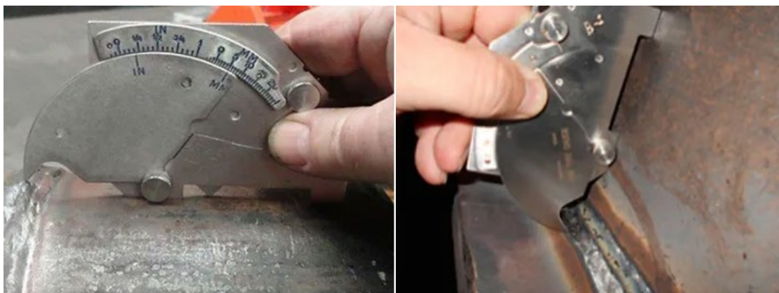
Figura 4.16 - Inspeção Visual e ferramentas utilizadas (escantilhões).
