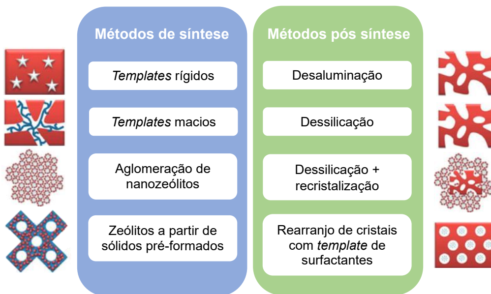
Figura 1.12 - Métodos de síntese e pós síntese para obtenção de zeólitos hierárquicos. Adaptado de [70, 72, 73]
