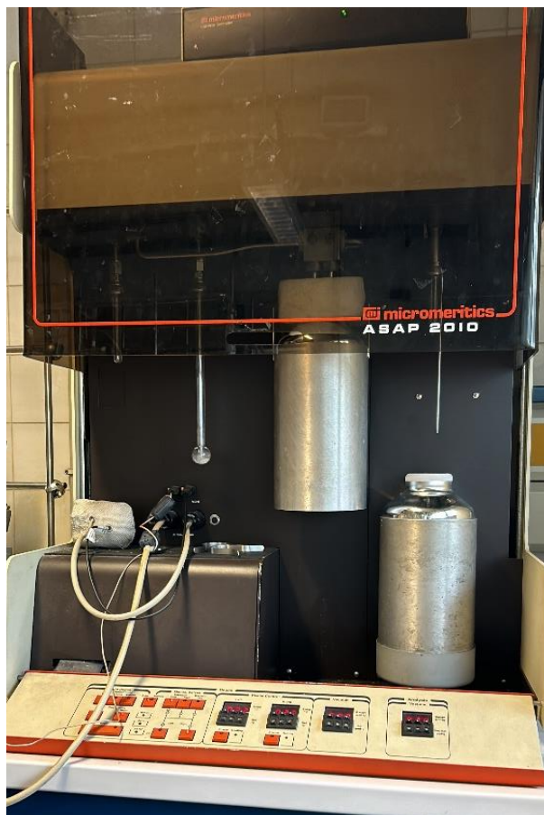
Figura 3.6 - Instalação e esquema representativo do equipamento Micromeritics ASAP 2010.
