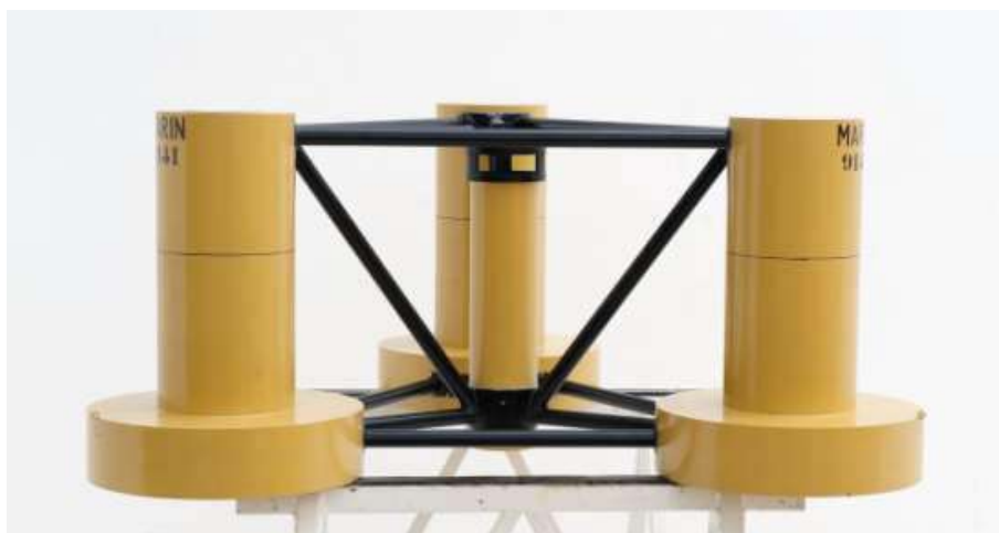
Figura 2.14 Plataforma flutuante DeepCwind (Adaptado de [26]).
