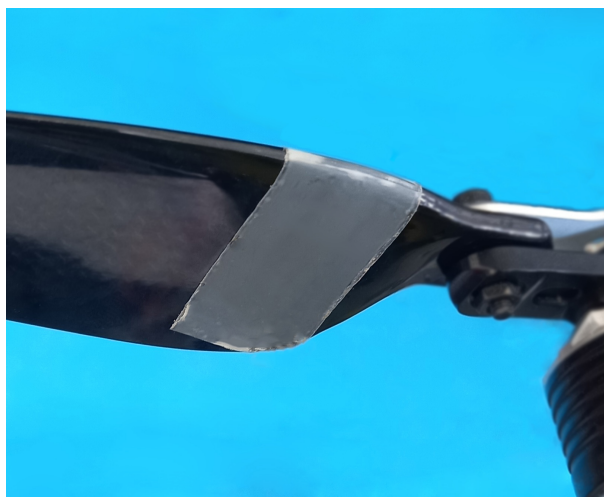
Figura 5.6 Alteração na pá para melhor detecção.
