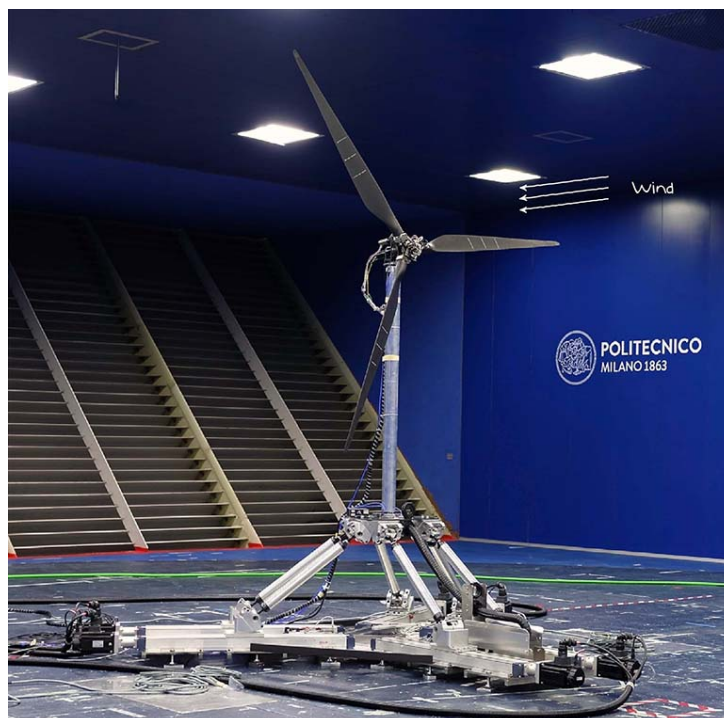
Figura 2.11 Plataforma com seis Graus de Liberdade (Adaptado de [25]).
