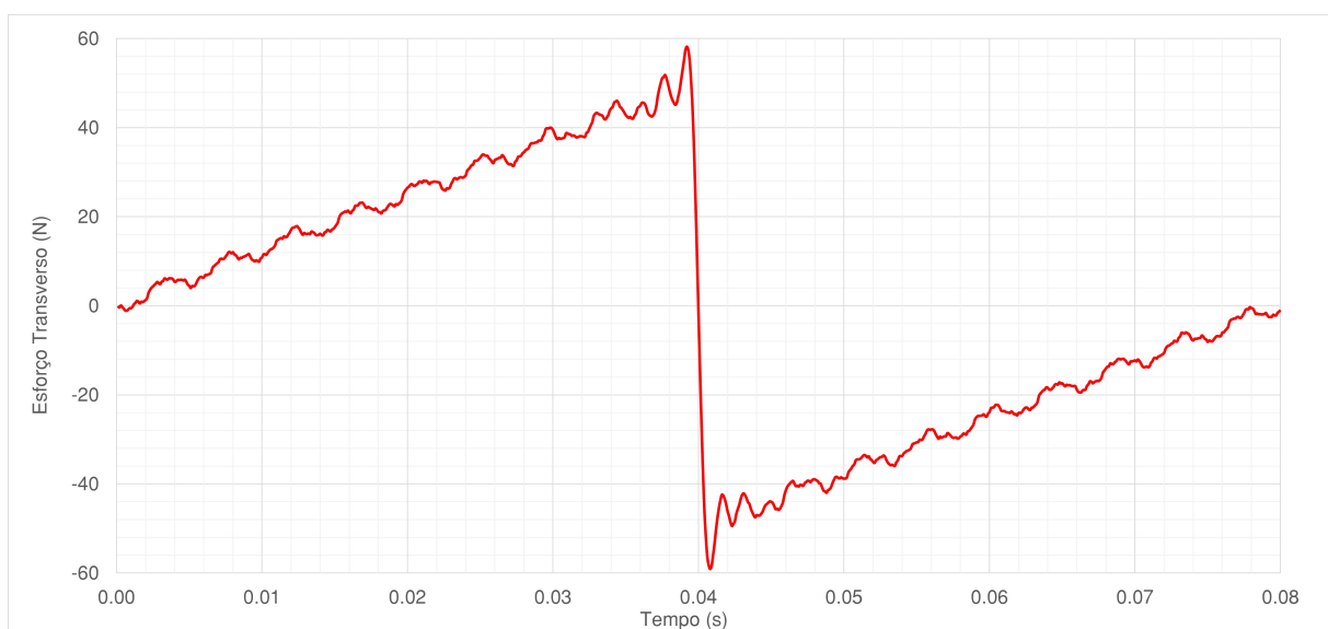
Figura 3.11 Esforço transverso a meio-vão (resposta não-amortecida)
