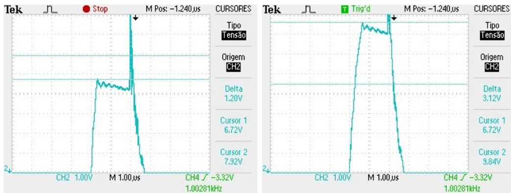
Figura 4.8.3- Forma de onda de V_{C5} quarto ensaio experimental, esquerda: Para uma temperatura de 35.28°C em T_c , direita: Para uma temperatura de 181.35°C em T_c (Ganho horizontal: 1 \mu s/div, Ganho vertical: 1 V/div)
