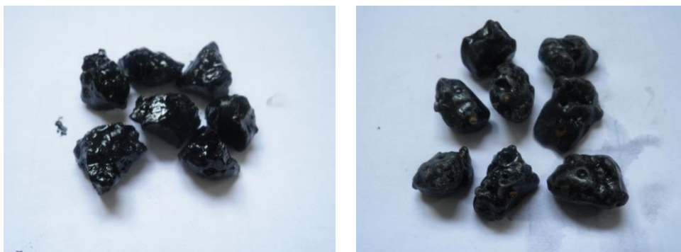
Figura 26 - ASIC envolvido em ligante antes e depois do ensaio de Afinidade
