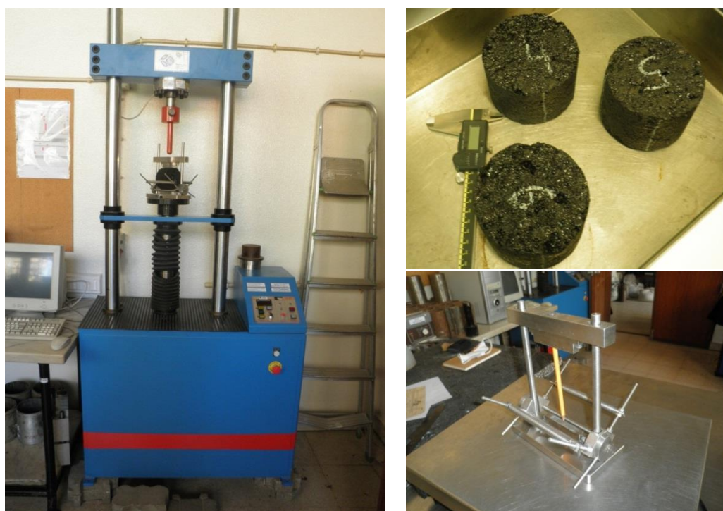
Figura 31 – Equipamento, provetes e suporte utilizados para avaliação da Sensibilidade à Água
