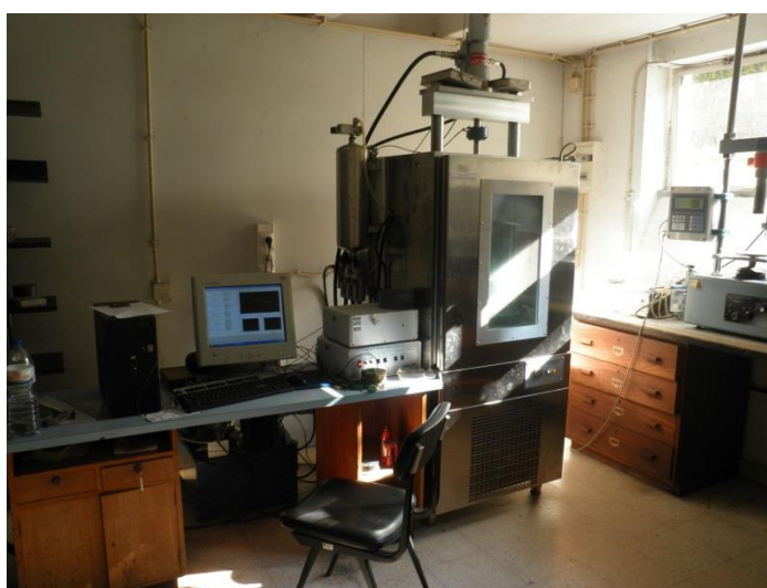
Figura 35 – Equipamento para ensaio de Resistência à Fadiga
