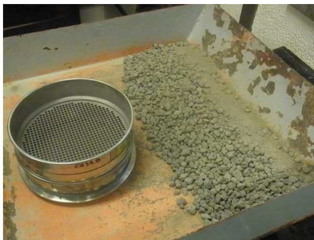
Figura 23 - Material resultante após realização do ensaio Los Angeles
