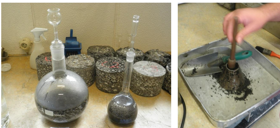
Figura 21 – Saturação das amostras nos picnómetros e utilização do método do cone
