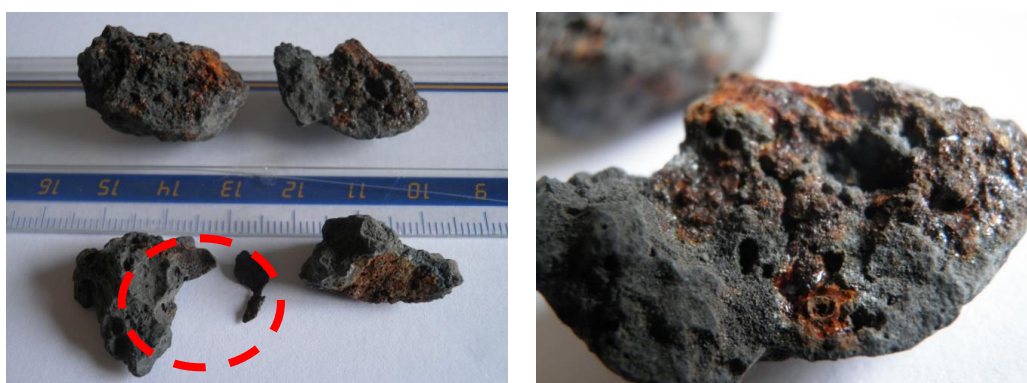
Figura 12 - Aspeto das escórias com presença de oxidação/corrosão e pedaços de ferro
