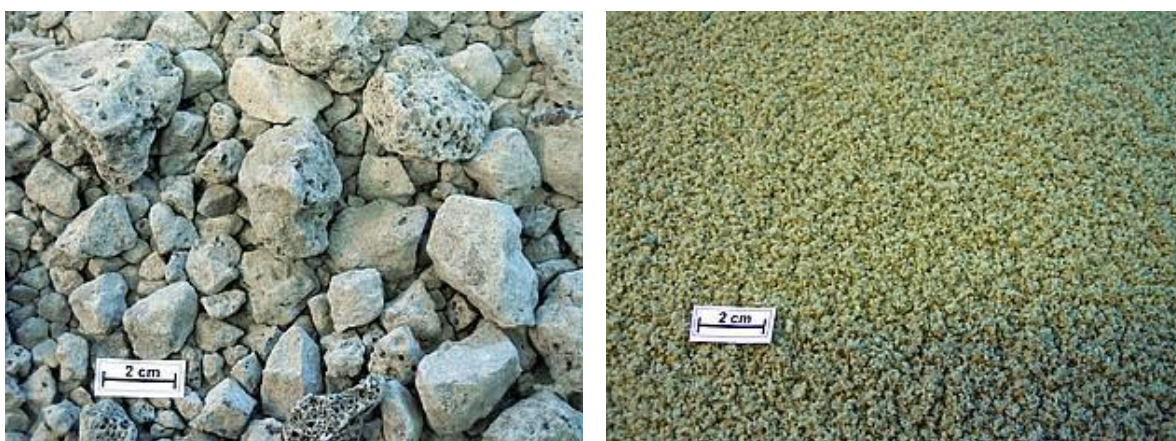
Figura 3 - Escória de alto-forno de arrefecimento lento à esquerda e de arrefecimento brusco à direita (EUROSLAG, 2014)
