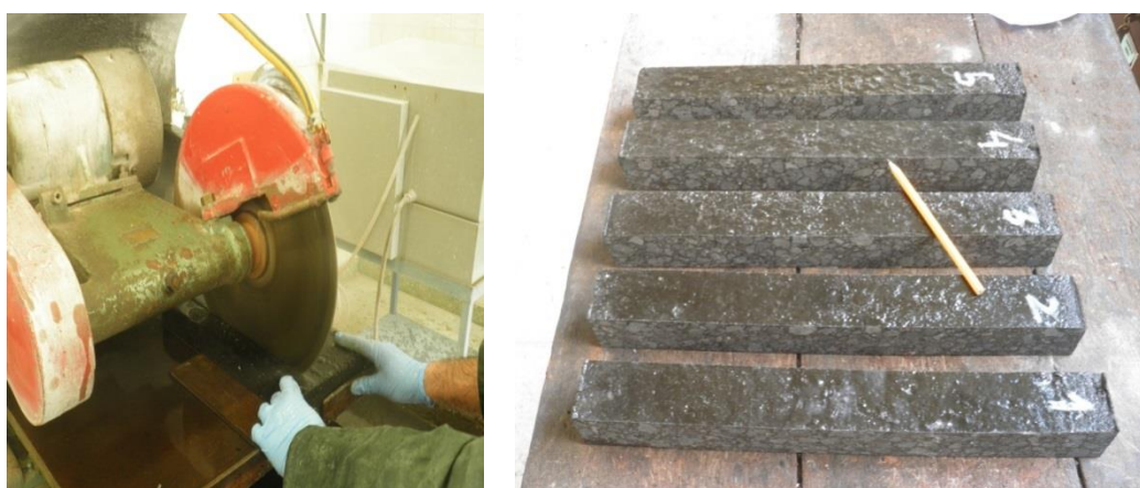
Figura 34 – Corte da laje e o primeiro conjunto de vigas para ensaio de Resistência à Fadiga
