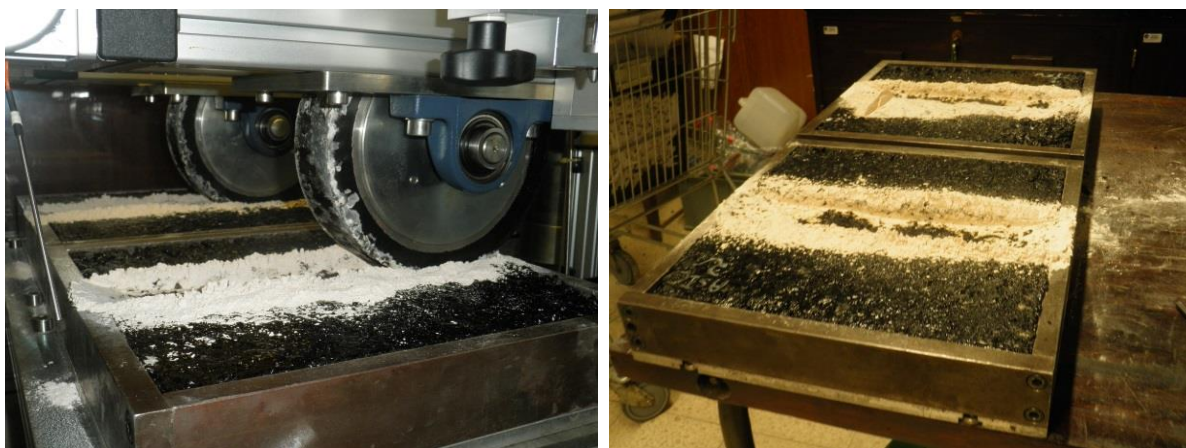
Figura 39 - Ensaio de Wheel Tracking e o aspeto final dos provetes
