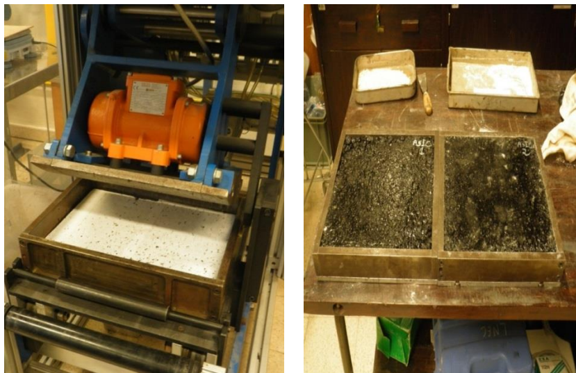
Figura 38 - Moldagem das lajes para ensaio de Wheel Tracking
