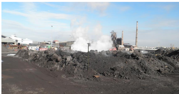
Figura 6 - Box de arrefecimento das escórias nas instalações da HARSCO na SN do Seixal
