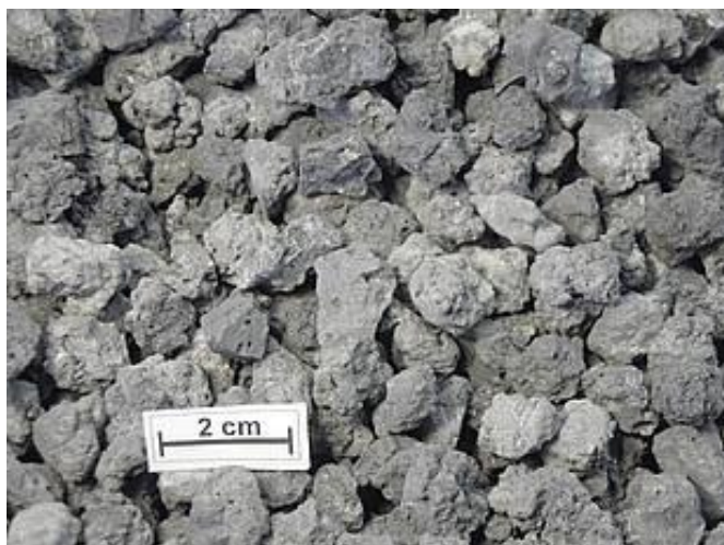
Figura 5 – Aspeto do ASIC proveniente do forno de arco elétrico ( EUROSLAG , 2014)
