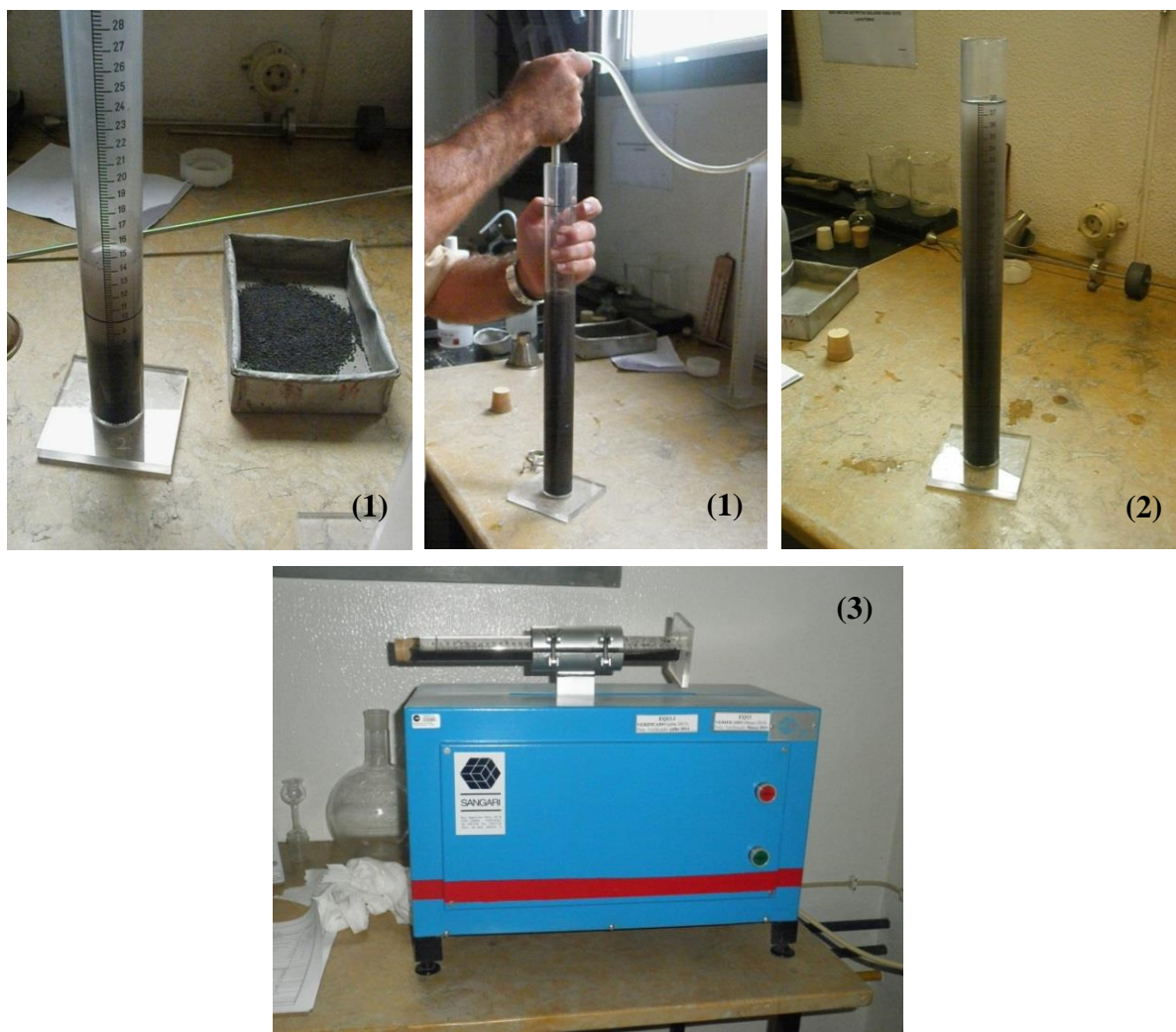
Figura 20 – Ensaio Equivalente de Areia e respetivo equipamento de agitação
