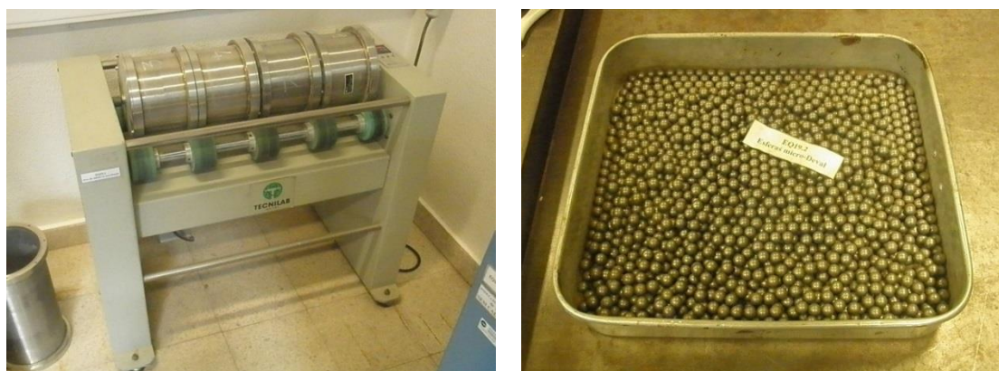
Figura 24 - Equipamento e esferas de aço para realização do ensaio Micro-Deval
