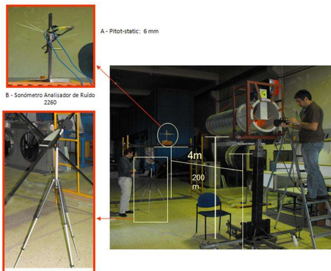
Figura 2 - Set up experimental para análise da intensidade do escoamento de ar e do ruído produzidos pelo ventilador. A - Pitot e B - Sonómetro.
